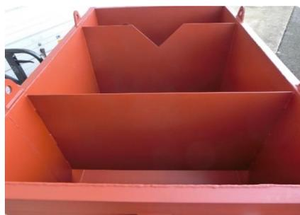
1枚目の仕切り板では下側を通すことで泥などを沈殿させやすく、2枚目の仕切り板では三角せきで上澄みだけを排水します。
